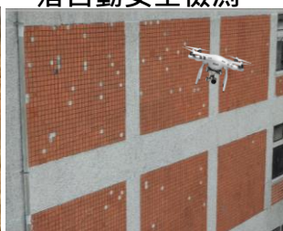
建築物外磁磚剝落自動安全檢測
