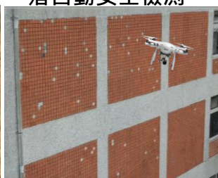
建築物外磁磚剝落自動安全檢測
