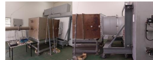
空調系統防火閘門耐火性能 及高溫洩漏與常溫洩漏試驗
