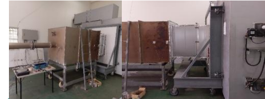
空調系統防火閘門耐火性能 及高溫洩漏與常溫洩漏試驗
